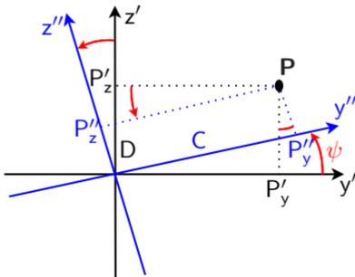
Abb. 3: Rotation  $\psi$  um die  $x'$ -Achse
