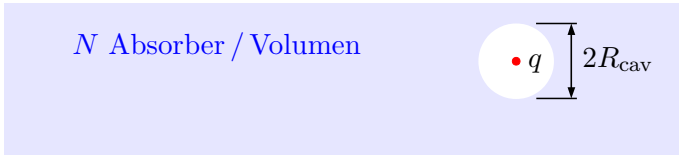
Abb. 5: Kavität im kontinuierlichen Absorber-Medium
