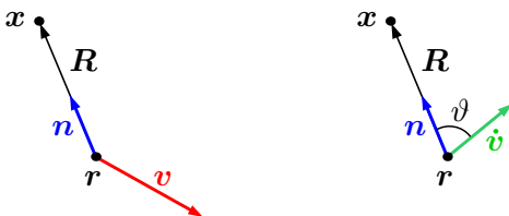
Abb. 2: Geschwindigkeit und Beschleunigung der Quelle
